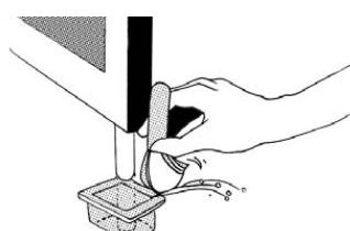
落し錠受け皿の土砂は、落し錠の掛かりが10mm以下になる前に取り除いて下さい。
